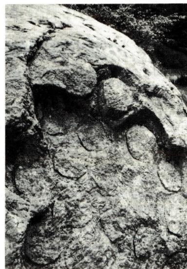
Masso di pietra ollare in Val Loana, presso Malesco (Val Vigezzo), con segni di estrazione di blocchi per la tornitura di lavecchi. (Foto Teresio Valsesia)
